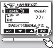
室内温度が設定温度を下回ると自動運転を開始し、温度を調節します。
