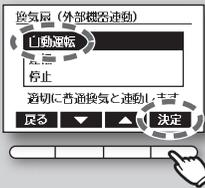
熱交換ユニットの「普通換気」と併せて換気扇を運転/停止します。
