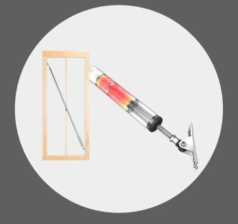
建物への衝撃(地震エネルギー)を 制振装置で熱に変えて吸収。
