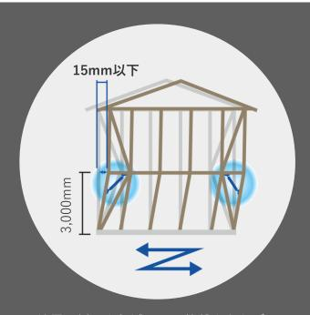
地震の揺れを軽減させて衝撃を和らげ、 家を傷めないようにする技術。 建物損傷が軽減されるため、 繰り返される余震に有効とされています。
