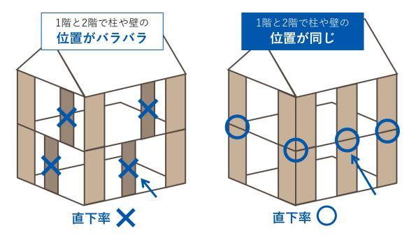
その耐力壁は、構造のどこに配置されるかによって発揮される効果が変わってきます。 耐震性を高める金物も同様にであり、配置に加えて何を用いるかによっても当然耐震性 は変化します。
