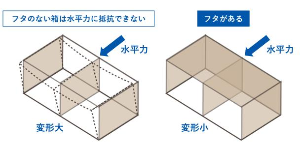
壁だけでなく、壁と直接つながっている床や天井などの「水平構面」も建物の耐震性に影響します。例えば2階が吹き抜けになっている構造などは耐久力が下がる原因になります。
