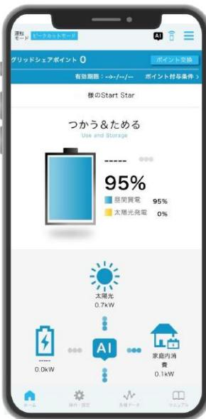
アプリ「蓄電池モニター」をスマートフォン・タブレットにダウンロードすることにより、いつでもどこでもエネルギー状況を確認でき、遠隔からでも蓄電システムの設定変更が可能です。
